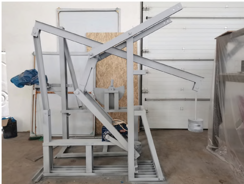
Рисунок 5 – Экспериментальный образец шестизвенного прямолинейно-направляющего преобразующего механизма привода
