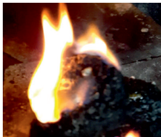
Рисунок 2 - Горение брикета состава 75 мас. % угля + 15 мас. % гудрона + 10 мас. % ПЭТФ
