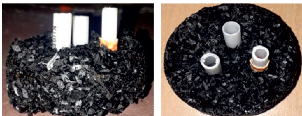
Рисунок 1 – Брикет с воздушными каналами
