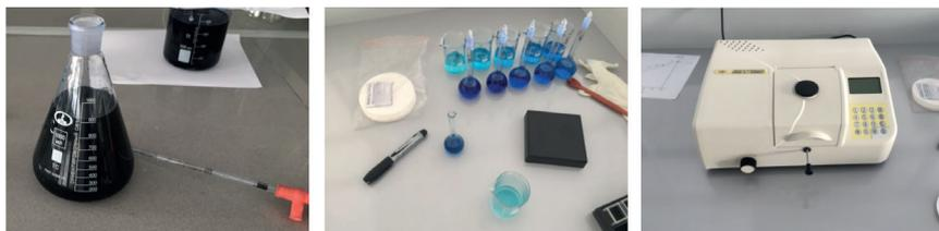
Рисунок 1 - Определение адсорбционной способности по ГОСТ 4453-74
