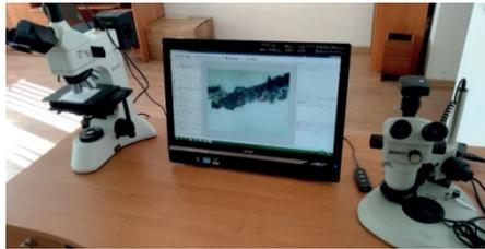
2 сурет – Альтами МЕТ 5Т әмбебап металлографиялық микроскопы
