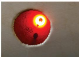
Рисунок 1 – Обжиг гранул керамдора во вращающейся печи
