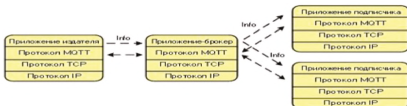
2-сурет - MQTT хаттамасының схемасы
