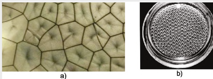
Рисунок 17 - Ячейки Бенара с силиконовым маслом ПМС-10 с алюминиевой пудрой (а) и (б) с разным увеличением [79].
