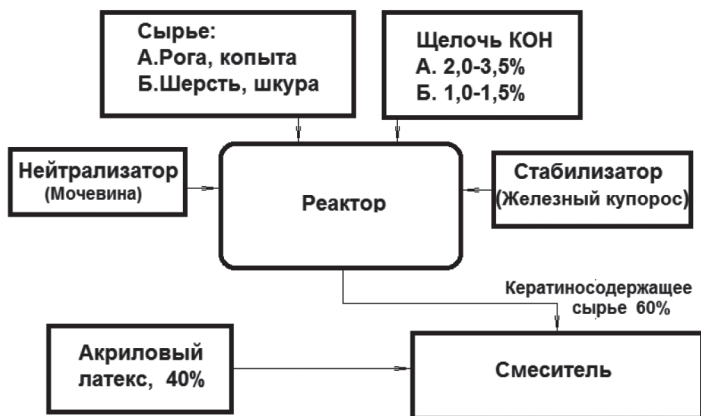
Рисунок 1 – Технология производства пропиточного состава
