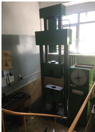
Рисунок 1 – Общий вид разрывной машины типа Р-100
