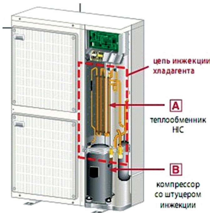
Рисунок 2 –Типичная схема компоновки ТН
