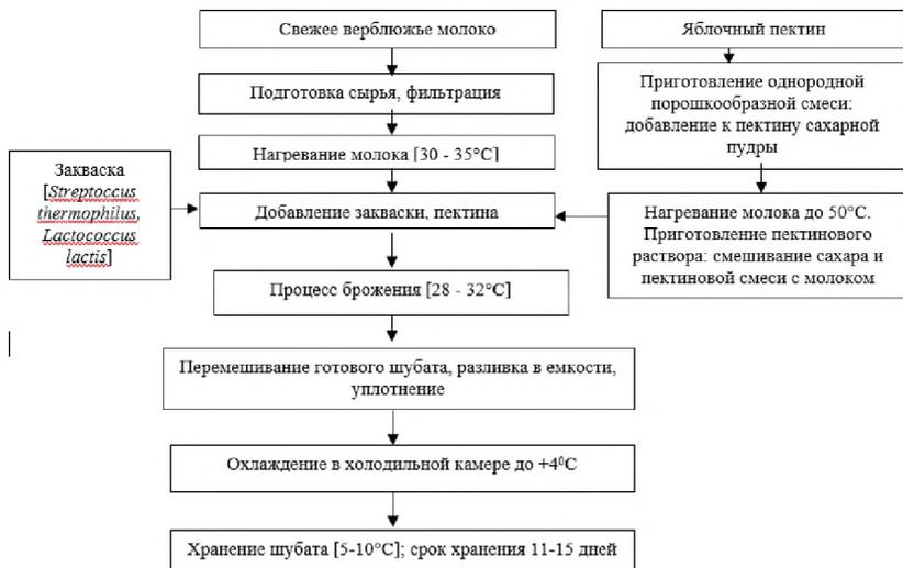
Рисунок 1 – Схема получения функционального пищевого продукта, пектинсодержащего шубата
