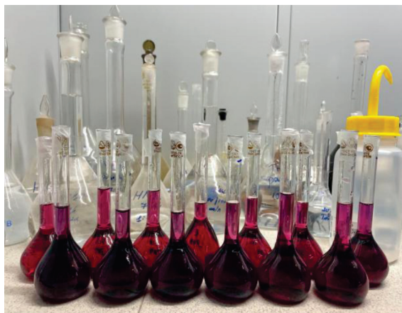
Рисунок 1 – Приготовление растворов скандия с Арсеназо (III) для спектрофотометрического анализа.
