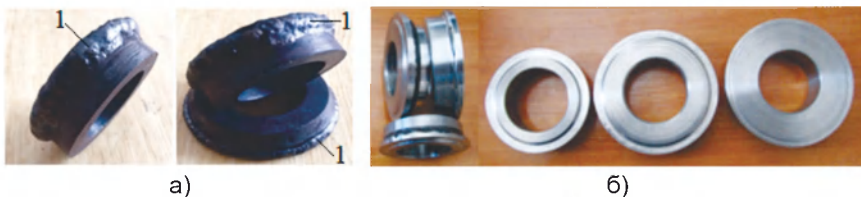
а – после наплавки; б – после механической обработки; 1 - наплавка.
