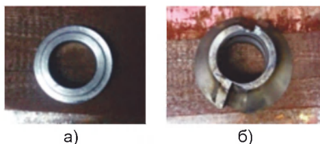
а) – чашечный резец; б) – конусная фреза трения Рисунок 4 - Образцы инструментов подвергшихся контролю
