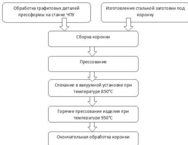
Рисунок 2 - Схема технологического процесса изготовления алмазных породоразрушающих инструментов с отдельной системой промывочных каналов
