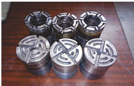
Рисунок 3 - Подготовленные к работе алмазные породоразрушающие инструменты с отдельной системой промывочных каналов
