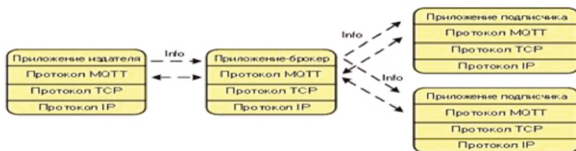
2-сурет - MQTT хаттамасының схемасы
