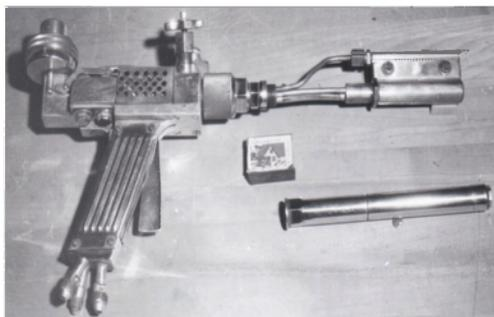
Рисунок 1 - Общий вид экспериментальной установки, выполненной в виде огнеструйной горелки ракетного типа. Камера сгорания и сверхзвуковое сопло охлаждаются капиллярно-пористой системой.
