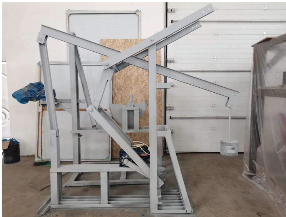
Рисунок 5 – Экспериментальный образец шестизвенного прямолинейно-направляющего преобразующего механизма привода
