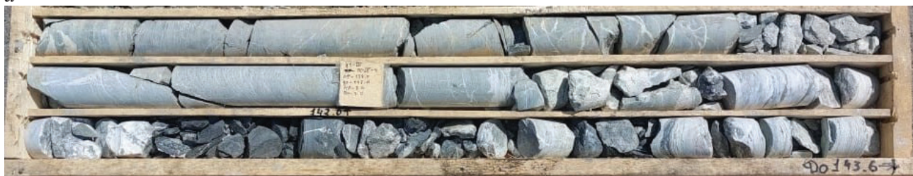
Рисунок 4 – Состояние отобранных керновых проб : а – алмазными буровыми коронками Ø95,6 мм с гидроструйным эффектом разрушения пород; б – серийными алмазными коронками КБ-ИЗАТ Ø95,6 мм
