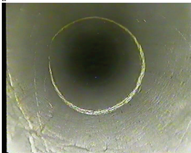
Рисунок 3 - Состояние стенки гидрогеологической скважины: а – пробуренные шарошечным долотом Ш-190,5СТ; б – пробуренные алмазной бурильной головкой гидроструйным эффектом разрушения пород диаметром 190,5 мм
