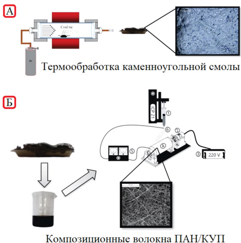
Рисунок 1 – Схематическая иллюстрация основных этапов получения композитных волокон: (А) подготовка каменноугольного пека и (Б) получение композиционных волокон на основе ПАН и КУП
