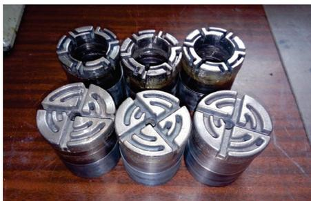
Рисунок 3 - Подготовленные к работе алмазные породоразрушающие инструменты с раздельной системой промывочных каналов
