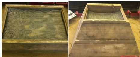
Рисунок 4- Послойная укладка модели дамбы с армированием
