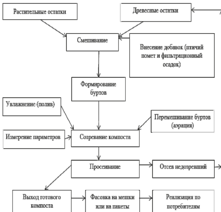
Рисунок 1 - Технологическая схема получения органоминерального удобрения из древесно-растительных отходов городского лесопаркового хозяйства
