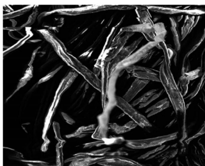
Рис. 2. Поверхность (а) обработанного и (б) необработанного волокна, полученного методом электронной микроскопии
