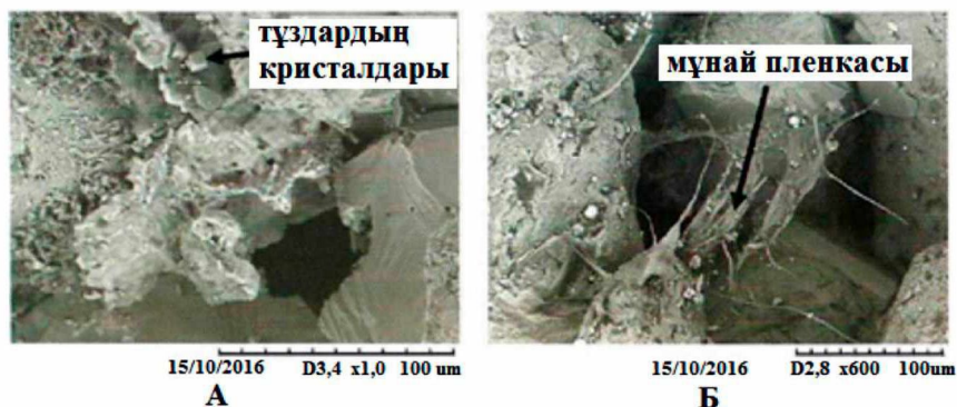
Сурет 3. Құмкөл кен орнындағы ұңғыма қимасынан алынған кварцты құмтас-тың электронды микроскоп көмегімен үлкейтілген үлгісінің кескіні: құмтас: А – орташа-майда түйіршікті; Б – ірі-орташа түйіршікті
