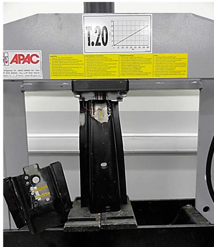
Рис. 1. Стойка и компенсационный элемент в испытательной машине ZD-10/90
