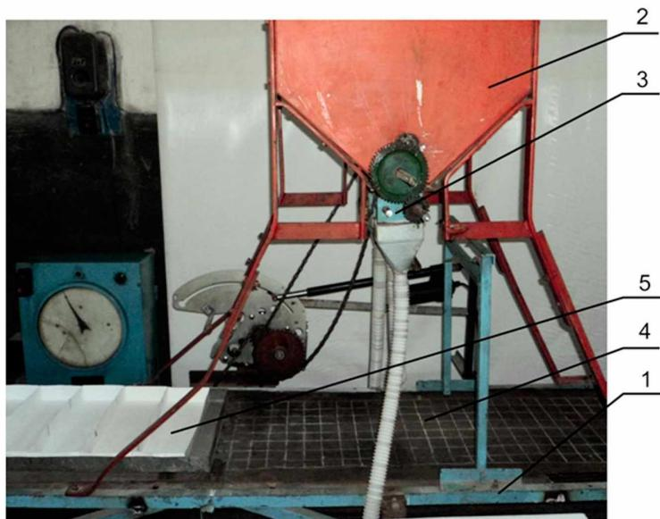
Рис. 1. Лабораторная установка: 1 – рама; 2 – бункер; 3 – высеивающее устройство; 4 – бегущая лента; 5 – противень
