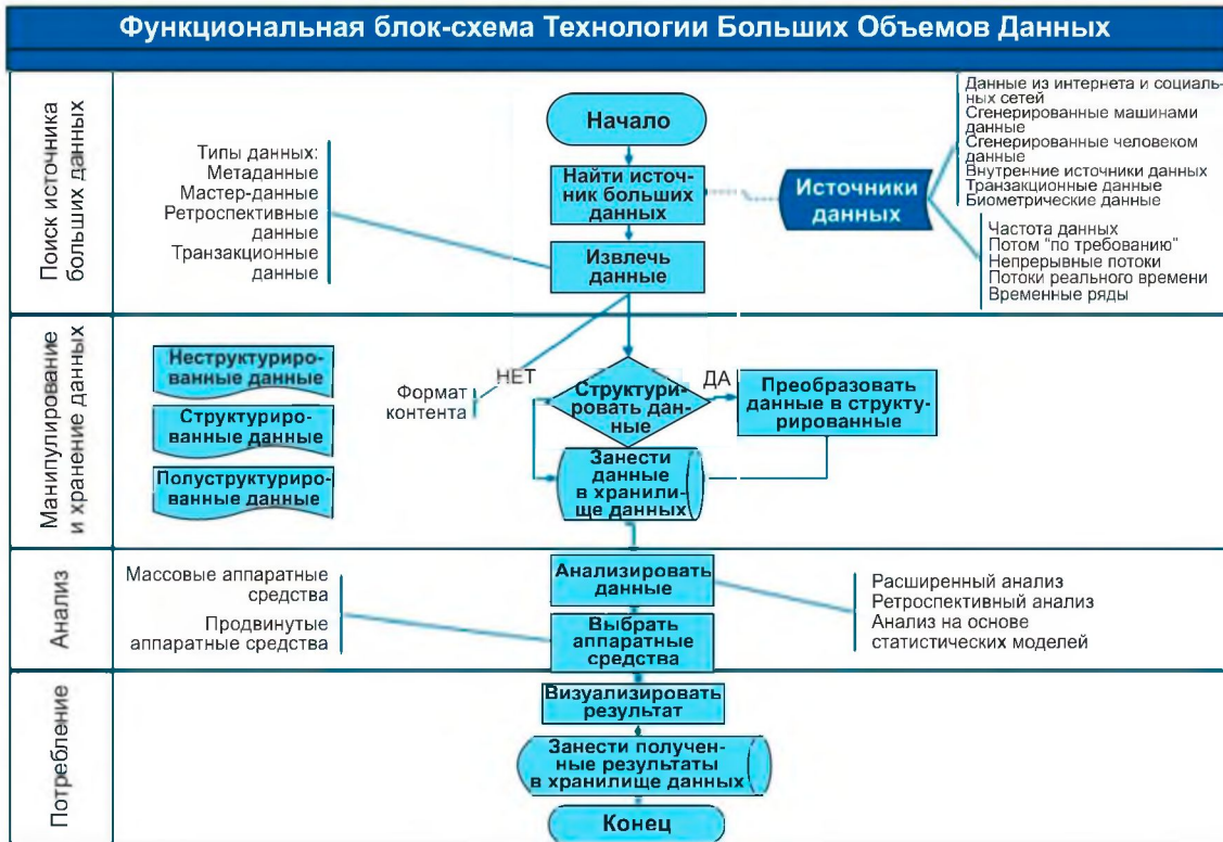
Рис. 9. Функциональная блок-схема технологии Больших объемов данных
