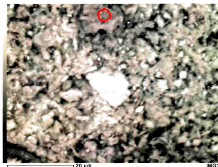
Рис. 2. Микроструктура бентонитовой глины Погодаевского месторождения
