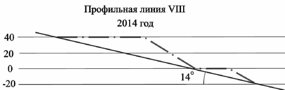
Рис. 3. Проектный профиль уступа внутреннего отвала (гор. 0)
