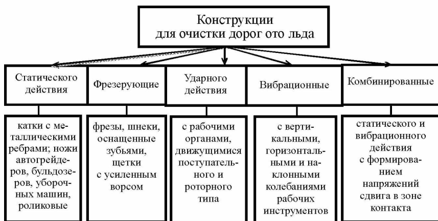
Рис. 1. Классификация рабочих органов для разрушения уплотненного снега
