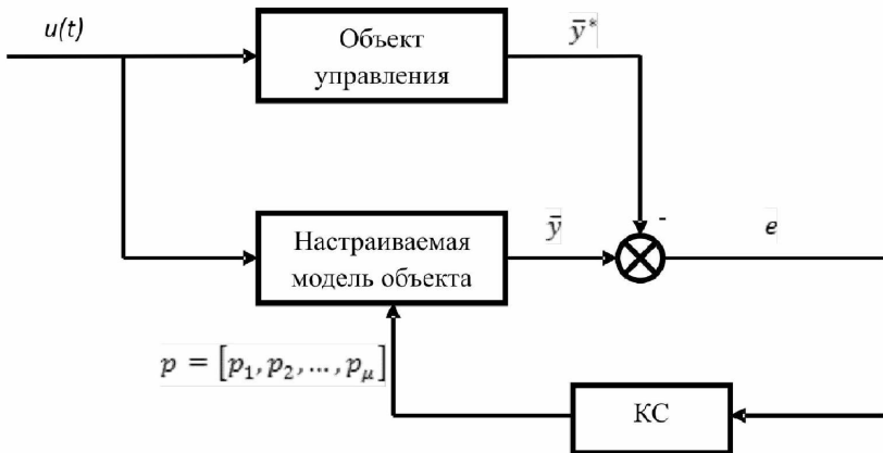
Рис.1. Схема настраиваемой модели
