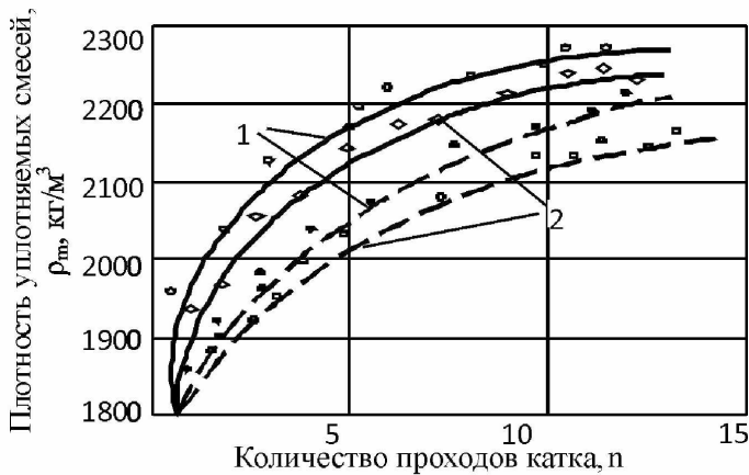
Рис. 9. Зависимость изменения плотности слоя \gamma_m от скорости V_k и числа проходов n катка (сплошной линией указан каток с гибким вальцом).
