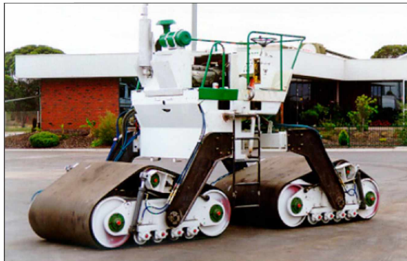
Рис. 1. Тандемный каток с двумя ведущими гибкими вальцами
