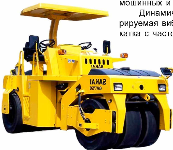
Рис. 2. Пневмовибрационный каток GW750 фирмы «Sakai»
