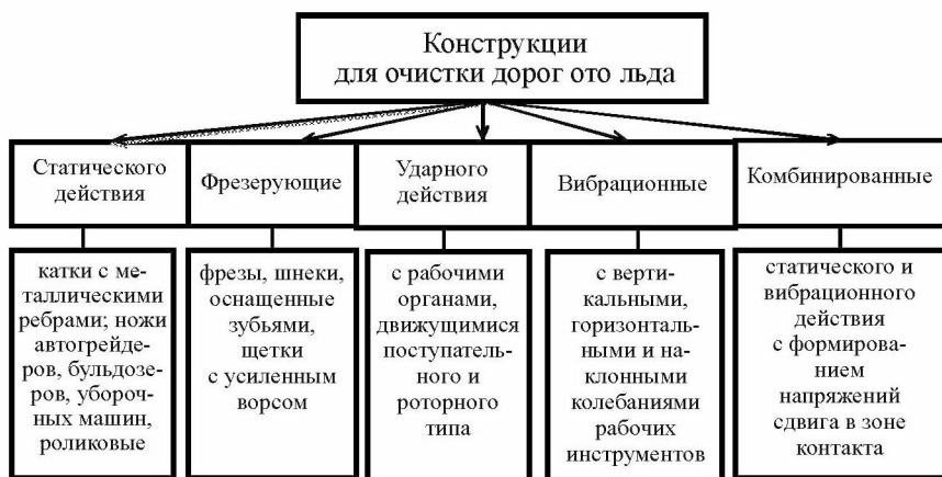
Рис. 1. Классификация рабочих органов для разрушения уплотненного снега
