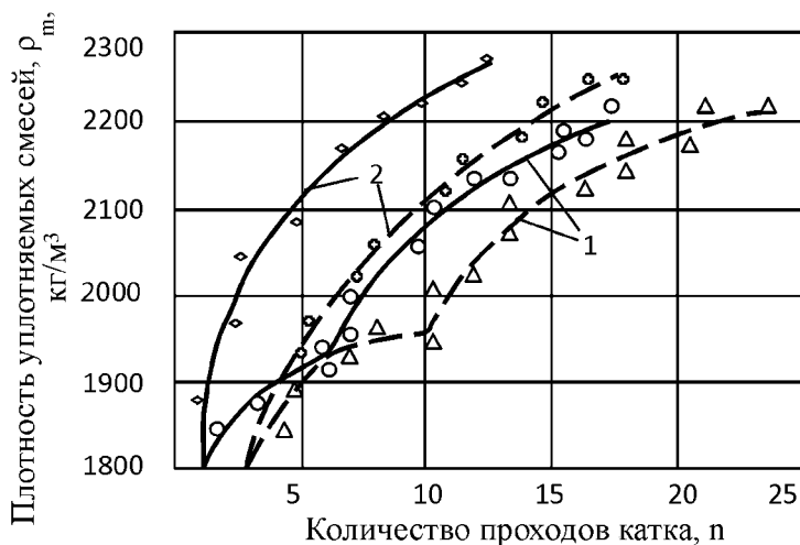
Рис. 8. Сравнительные характеристики изменения плотности уплотняемых смесей \rho_m в зависимости от проходов катка n
