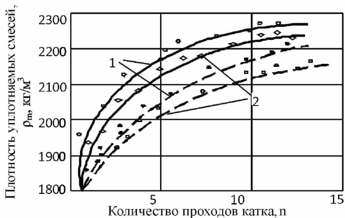
Рис. 9. Зависимость изменения плотности слоя \rho_m от скорости V_k и числа проходов n катка (сплошной линией указан каток с гибким вальцом).
