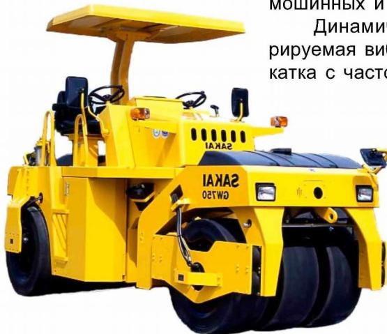
Рис. 2. Пневмовибрационный каток GW750 фирмы «Sakai»
