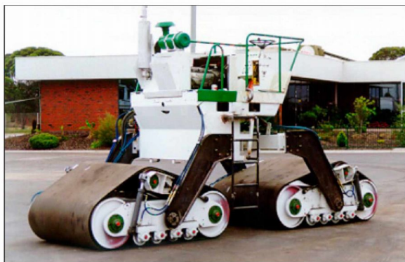
Рис. 1. Тандемный каток с двумя ведущими гибкими вальцами
