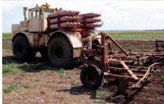
Рис. 1. Система распределенной подачи газообразного топлива на тракторе К-700А
