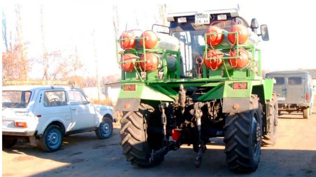
Рис. 2. Система с центральной подачей газообразного топлива на тракторе РТМ-160
