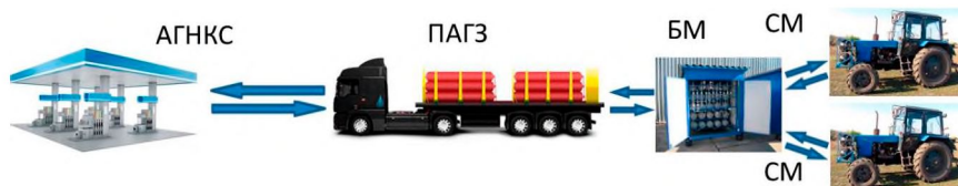
Рис. 1. Заправка с использованием ПАГЗ и узла промежуточного хранения природного газа в виде баллонных модулей
