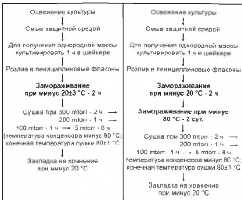
Схема I и II варианта лиофильного высушивания азотфиксирующих микроорганизмов
