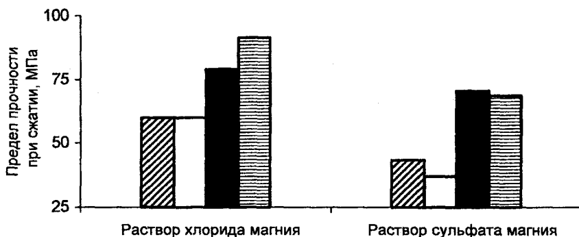
Рис. 2. Влияние вида затворителя (KM – каустический магнезит; GM – гипсомагнезиальное вяжущее) на твердение гипсомагнезиального вяжущего, сут.: ▨ – KM 10; □ – GM 10; ■ – KM 60; ▩ – GM 60
