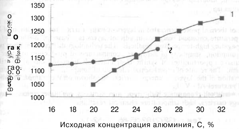
Рис. 3. Зависимость температуры в волне горения от состава: 1 - (Al + V 2 O 5 ) + Al 2 O 3 ; 2 - (Al + V 2 O 5 ) + V 2 O 5
