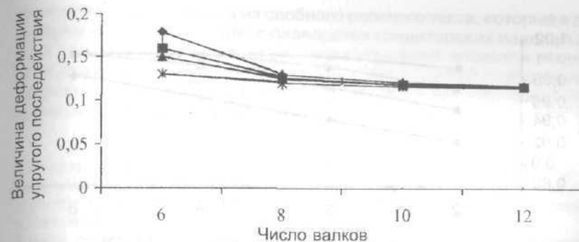
Рис. 2. Зависимость величины деформации упругого последействия от числа валков для сдобного слоеного теста: ◆ - V_{\text{рот}}/V_{\text{тр}}=2 ; ■ - V_{\text{рот}}/V_{\text{тр}}=3 ; ▲ - V_{\text{рот}}/V_{\text{тр}}=4 ; x - V_{\text{рот}}/V_{\text{тр}}=6
