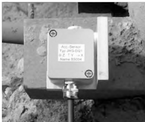
Рис. 2. Измерительный датчик JHG-2 для определения частот на Бухар-Жырауском мосту
