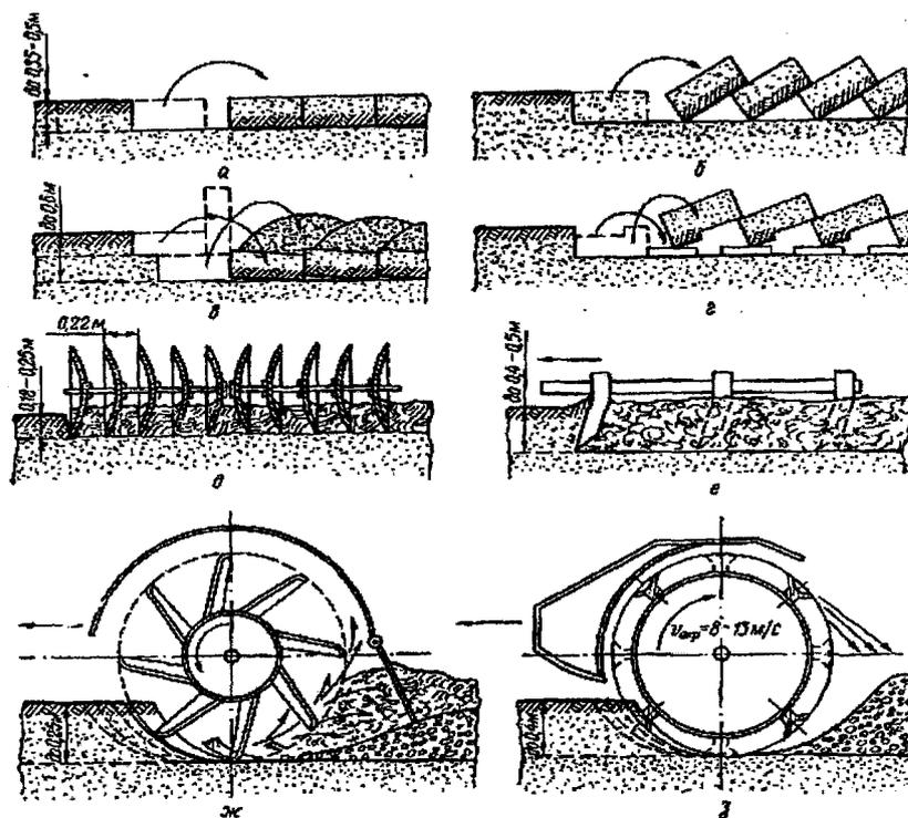
Схема воздействия на загрязненную почву рабочих органов машин при ее первичной обработке после сбора поверхностных жидких токсичных веществ:
