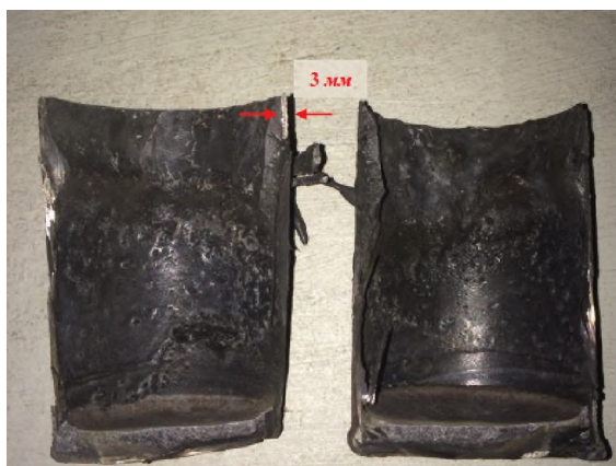
Рисунок 3 – Общий вид реактора после проведения опыта: T = 500\text{ }^\circ\text{C} , \tau = 10\text{ ч} .
