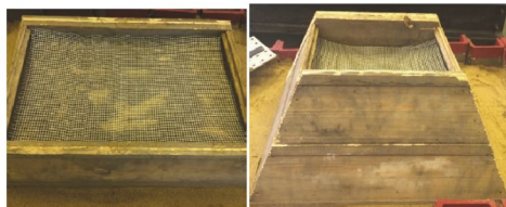
Рисунок 4- Послойная укладка модели дамбы с армированием
