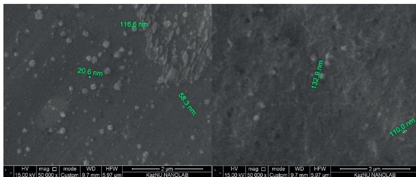
Рисунок 3 - Фотографии НЧ меди, полученные с помощью ЭСМ концентрация \text{CuSO}_4 (а) - 0,06г/л; (б) - 0,07г/л.
