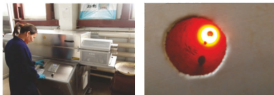
Рисунок 1 – Обжиг гранул керамдора во вращающейся печи
