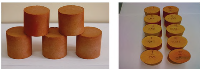
Рисунок 6 - Лабораторные термообработанные образцы цилиндров при температуре 1000 o C
