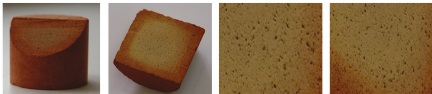
Рисунок 7 - Пористая макроструктура (в срезе) термообработанных образцов цилиндров при температуре 1000°С
