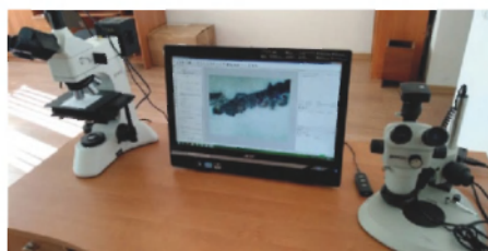
2 сурет – Альтами МЕТ 5Т әмбебап металлографиялық микроскопы
