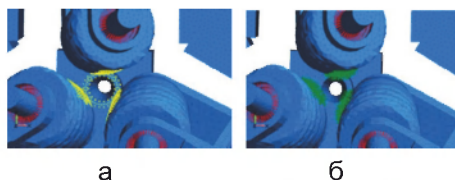
Рисунок 4 – Приложение момента (а) и силы (б) к рабочим валкам
