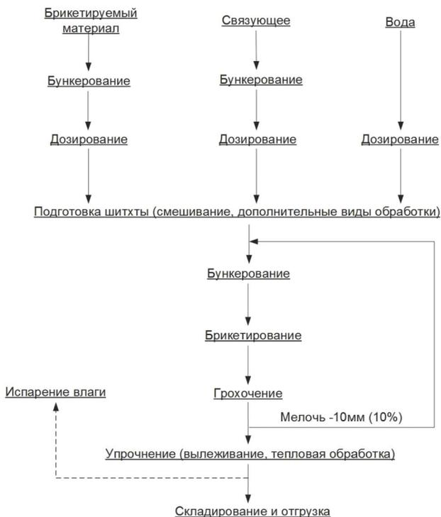
Рисунок 3 - Технологическая схема
