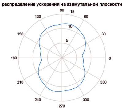
Рисунок 6 - Распределение ускорений в азимутальной плоскости в уровне 26 этажа
