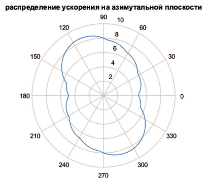
Рисунок 7 - Распределение ускорений в азимутальной плоскости в уровне 21 этажа
