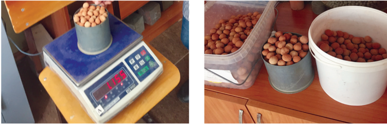
Рисунок 3 – Лабораторные термообработанные образцы гранул в интервале температур 950 - 1000 °С
